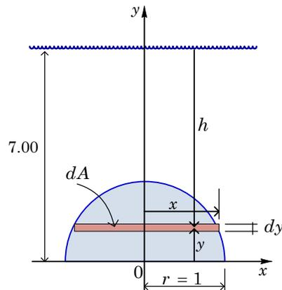
Como la compuerta tiene forma circular de radio 1, con el centro de la circunferencia en el origen del sistema de coordenadas, la ecuación es
