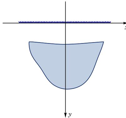
Para calcular la fuerza ejercida por el fluido sobre la compuerta, es necesario suponer que la compuerta está formada por una cantidad infinita de diferenciales de área, de tal forma que cada diferencial de área está sumergido a una profundidad  $h$ .
