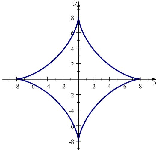
Como se observa, la gráfica es simétrica respecto a ambos ejes, por lo que para calcular la longitud total de la curva, será suficiente con calcular la longitud de la curva en el primer cuadrante y multiplicar el resultado por 4, es decir
