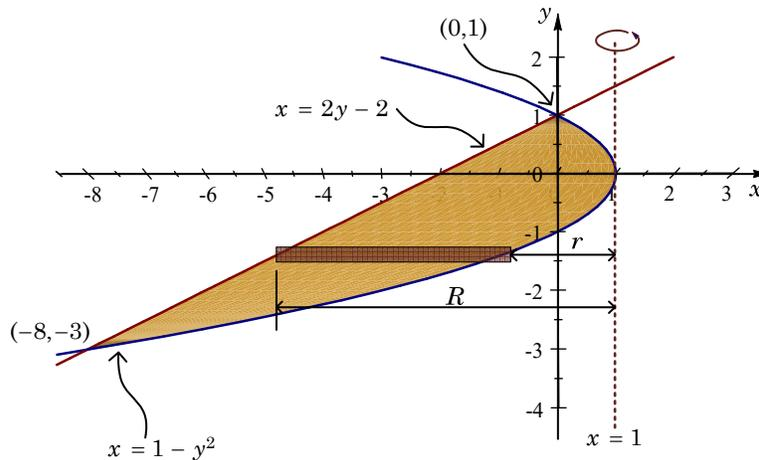
En la siguiente figura se muestra un dibujo aproximado del sólido de revolución, se dibuja también un elemento diferencial que tiene la forma de un anillo, con centro en la recta  $x = 1$
