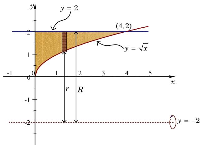
En la siguiente figura se muestra un dibujo aproximado del sólido de revolución, se dibuja también un elemento diferencial que tiene la forma de un anillo, con centro en la recta  $y = -2$
