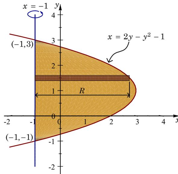
En la siguiente figura se muestra un dibujo aproximado del sólido de revolución, se dibuja también un elemento diferencial que tiene la forma de un disco
