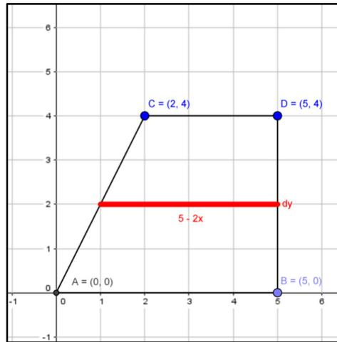
Grafica 2: Sección transversal del tanque, colocada en un plano cartesiano
