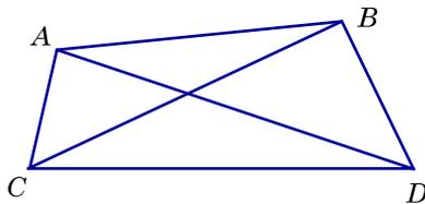
21. Para determinar la distancia entre dos puntos Inaccesibles  $A$  y  $B$ , un topógrafo mide la distancia  $CD = 218$  pies y los ángulos  $\angle BCD = 33^\circ$ ,  $\angle BDC = 74^\circ$ ,  $\angle ADC = 21^\circ$  y  $\angle ACD = 80^\circ$ , como se muestra en la figura. Calcule la distancia  $AB$ .
