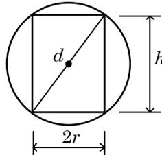
En la figura de arriba  $d$  es el diámetro de la esfera,  $h$  es la altura del cilindro y  $2r$  es el diámetro del cilindro. Como el triángulo formado por estos segmentos es rectángulo, al utilizar el teorema de Pitágoras se tiene
